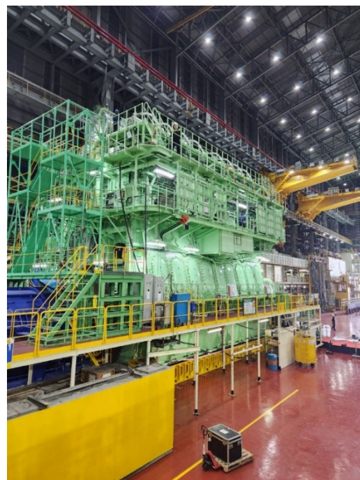
搭载MET增压器的甲醇双燃料发动机 (MAN ES 8G95ME-C10.5-LGIM)
