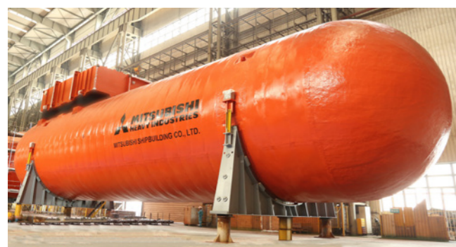
LNG Fuel Tank
