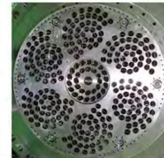
図5 マルチクラスタ燃焼器（開発中）
