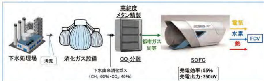
図10 消化ガス発電のイメージ
