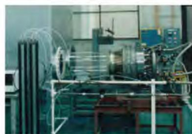
図5 気流試験装置の写真
