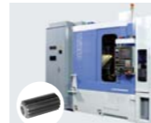
1997 切削油を一切使わない、世界初のドライカット歯車加工システムを完成
