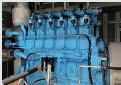
6気筒500kWクラス水素専焼エンジン(試作機)
