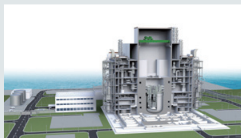
ナトリウム冷却タンク型高速炉 (経済産業省委託事業研究成果を含む)
