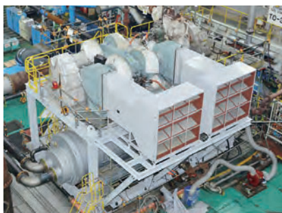
ダブルフローギアドコンプレッサ
