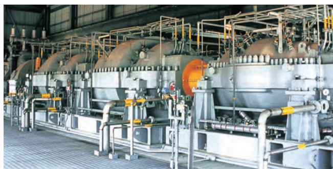
エチレンプラント用分解ガスコンプレッサ・蒸気タービン
