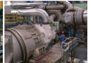
Завод терефталевой кислоты (привод компрессора со встроенным редуктором)
