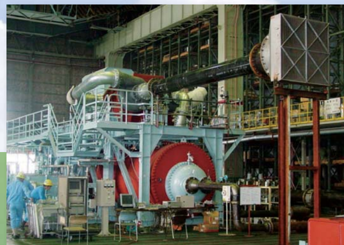
Дожимный воздушный компрессор для электростанции с комбинированным циклом комплексной газификации
