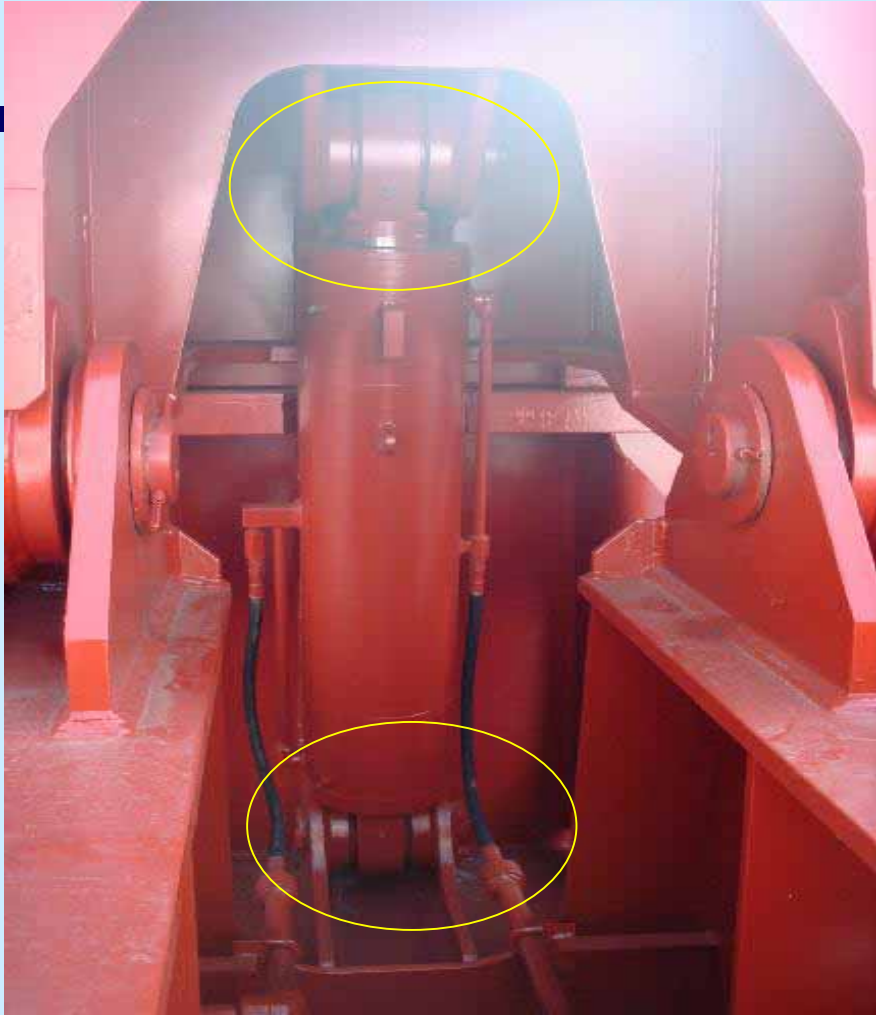
ハッチカバー開閉装置
