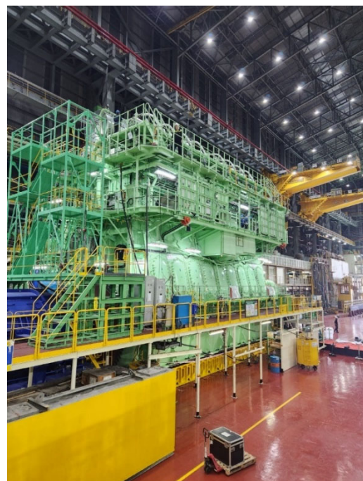
MET過給機が搭載されたメタノール2元燃料主機関(MAN ES 8G95ME-C10.5-LGIM)
