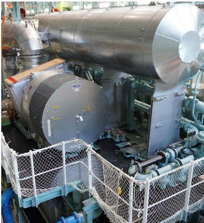
搭配MET66MBII增压器氨燃料大型低速双燃料发动机
