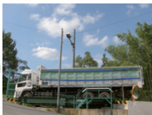
空荷車両出庫時、停車して約20秒計測 登録済み車両の場合は計測不要
