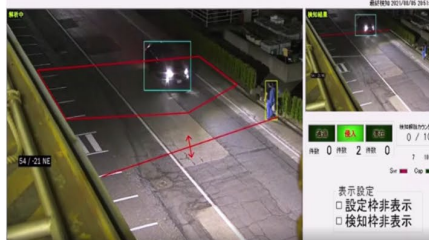
AI技術による侵入検知、旋回カメラによる自動追尾等の高度化実現
