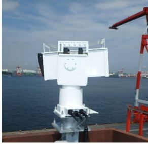
暗視性能に優れた高感度・大望遠・旋回カメラによる広域監視
