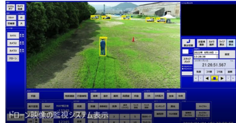
UAV (ドローン) 搭載カメラによる空撮映像連携による監視 (エッジコントローラAIによる自動追尾も含む)
