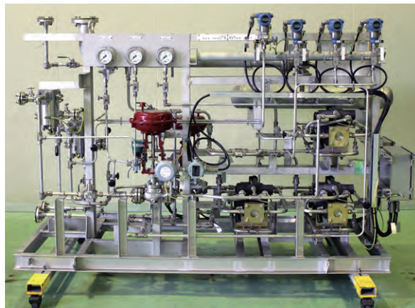
高圧ガス昇圧装置
