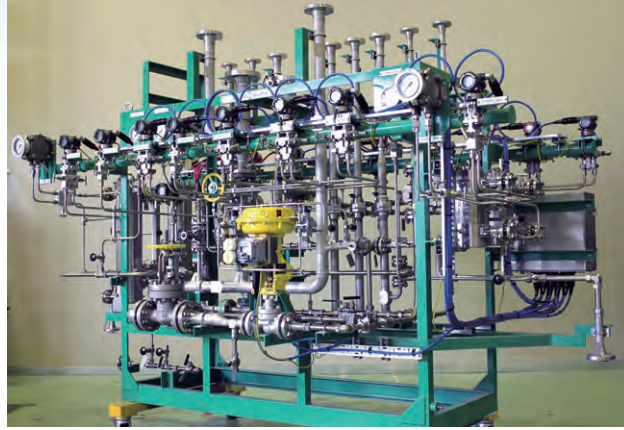
高圧ガス制御ユニット (GAS SEAL CONTROL UNIT)
