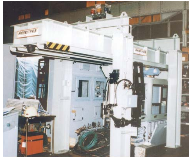
懸垂型 鋼板反搬送基準側製作例
