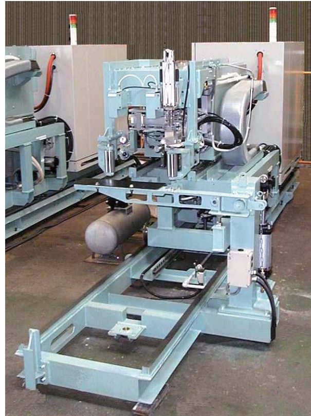
定置型 鋼板搬送基準側製作例
