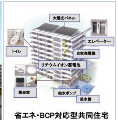
三菱重工業株式会社 横山台社宅 構造：RC造 階数：地上10階建 延べ面積：21,208㎡ 竣工：2016年
