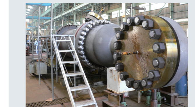
高温高圧熱交換器
