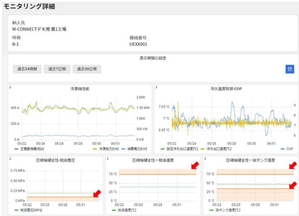
図3 冷凍機の閾値と計測値を1つのグラフ上で確認可能なモニタリング画面(例)
