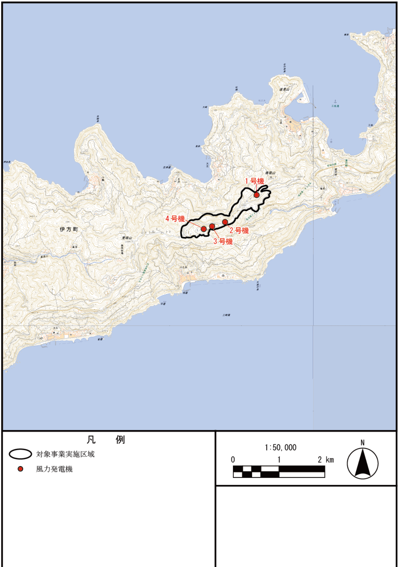
図 2.2-2 風力発電機の配置計画
