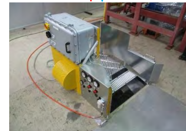
ステーション (非接触給電および保護ガス補充充填)
