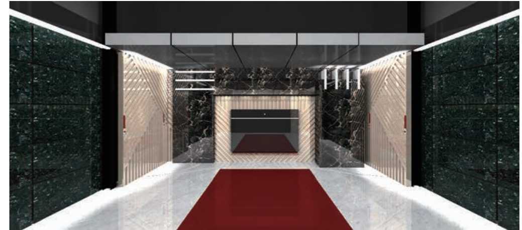
床:天然石/壁:天然石・金属パネル/天井:アルミパネル
