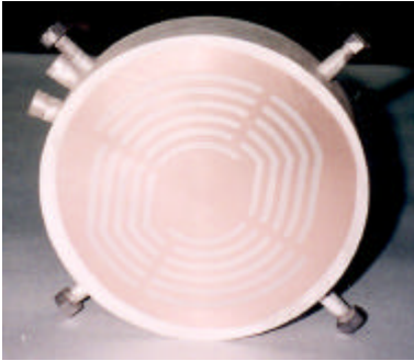
図1 溝内部に充てんされたワックス上に銀粉を擦り込んだコイルの母材
