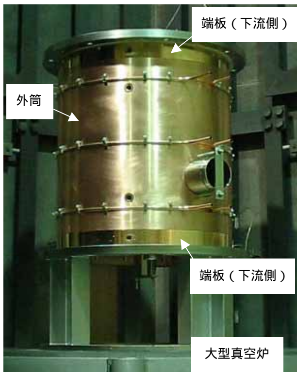
図4：空洞ろう付け
