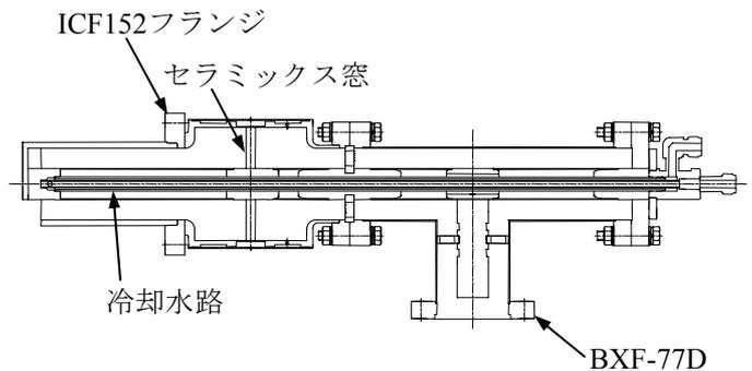
図2: 77D同軸型カップラー
