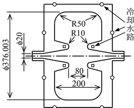
図1: 空洞構造
