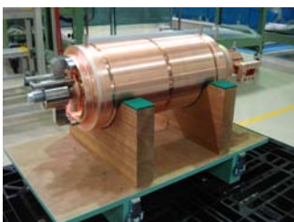
図5：共振空洞ユニット組立
