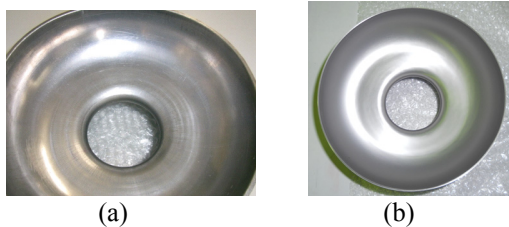
図6 : (a)自動バフ研磨前, (b) 自動バフ研磨後
