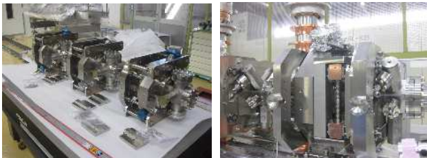
図 5：超伝導空洞(左図),周波数チューナ (右図)
