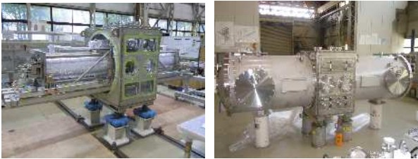
図 10：主加速部モジュールの工場組立確認の様子
