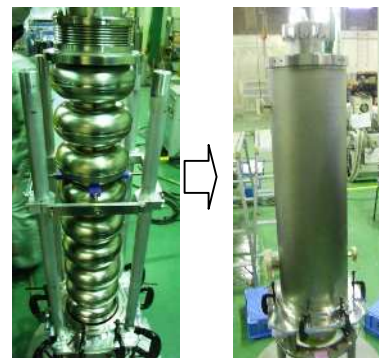
図 8：空洞ジャケット化の様子 ( 9 セル超伝導空洞のジャケット化前 空洞ジャケット化後 )
