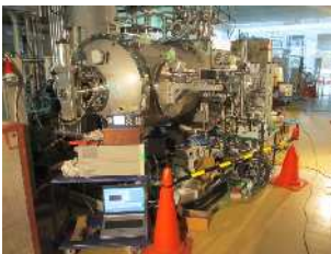
図 12：主加速部モジュール冷却試験の様子
