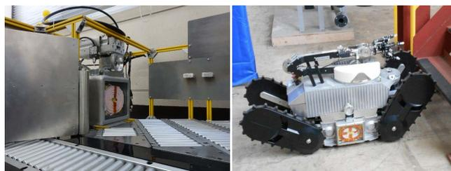
図7 防爆の非接触給電システムの外観
